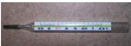
O mercúrio é um metal que se dilata acentuadamente com o aumento de temperatura, por isso é utilizado em termômetros.
